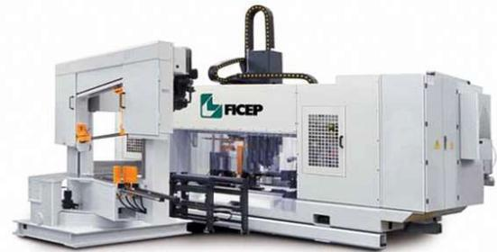
Maschine zum Schneiden und Bohren von Profilen, die anspruchsvollste Aufgaben bei Metallkonstruktionen durchführen kann.
